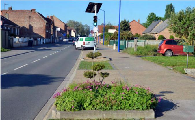
**R**oute d'Arras, un feu récompense a été installé. Il est paramétré pour être rouge en l'absence de véhicule et bascule au vert lorsque la vitesse des véhicules détectés en approche est en-dessous des 50km/h. Les couleurs se déroulent cycliquement vert-orange-rouge. Lorsqu'il n'y a plus de véhicule en approche, il repasse au rouge.
